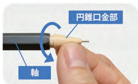
2. パイプ部に同じ太さの替芯を先端から差し込んで折れた短い残り芯を取り除く。
