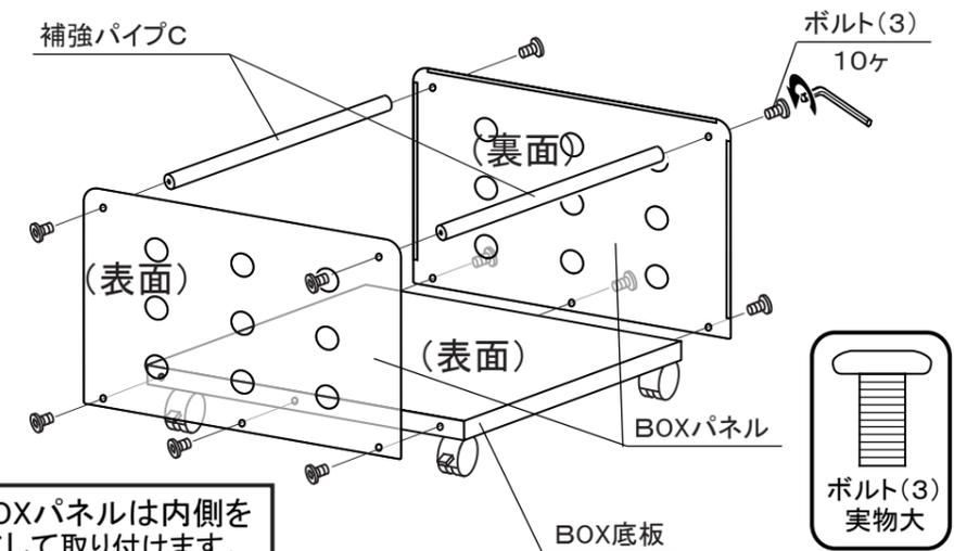
(注)BOXパネルは内側を裏面にして取り付けます。
