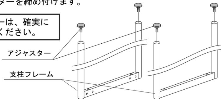
2) 支柱フレームを (仮締め) します。
