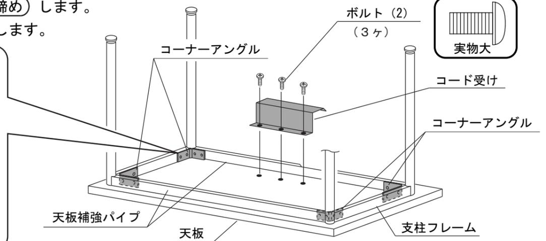
5) 1) (仮締め) した全ての ボルト を締め付けてください。
