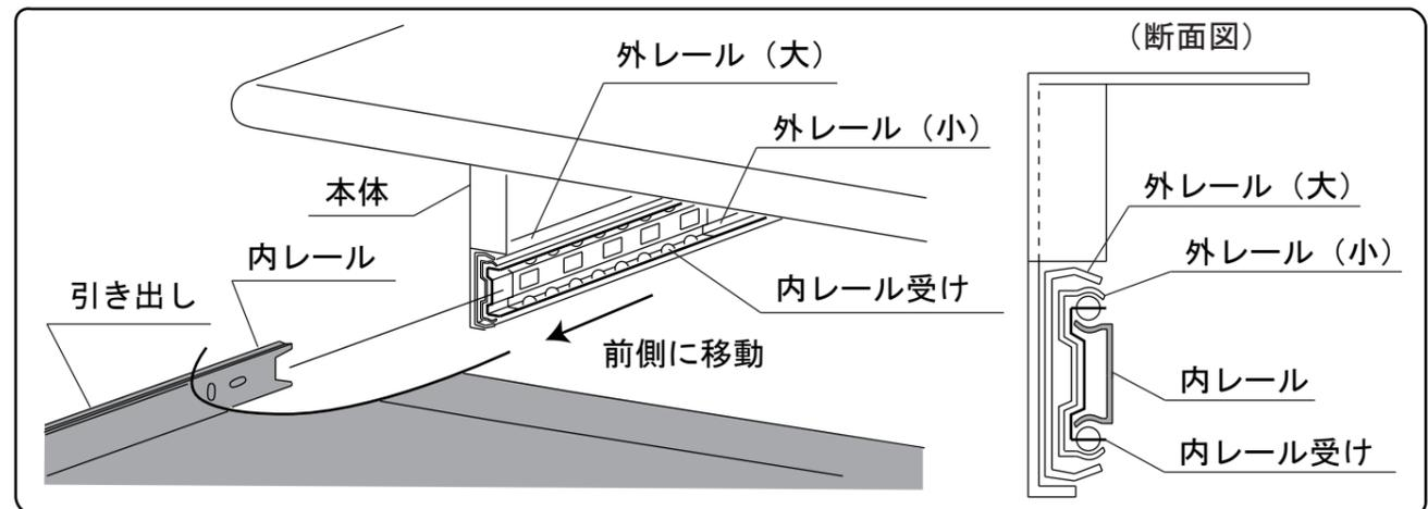
※ 外レール (小) に組み込まれている内レール受けを前側に移動します。引き出しの左右内レールを外レール (小) の内レール受けに、一番奥までさしこみます。
