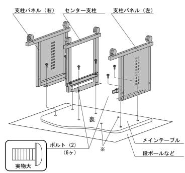
4) 支柱パネル(右)、センター支柱に間口パネルとオーバートップフレームを (仮締め) します。(間口パネルのコードホールは、右側になります。)
