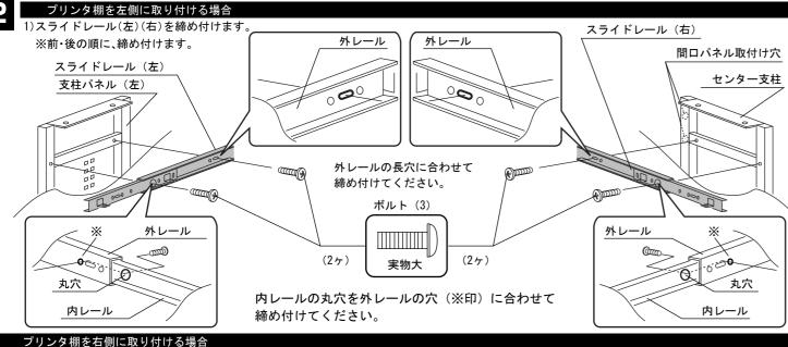
1) 2 で支柱パネル(右)にスライドレール(右)を締め付けます。
