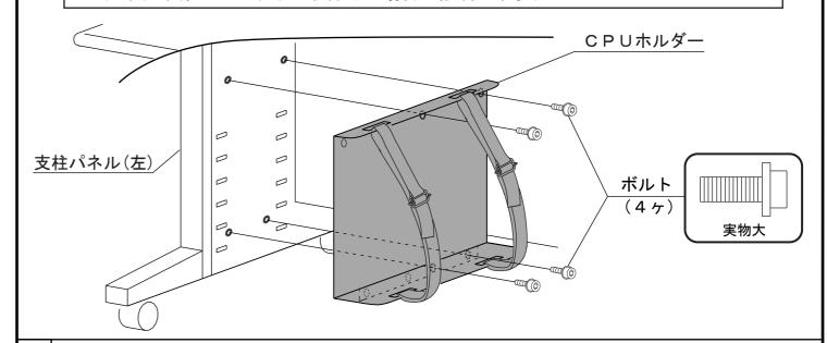
1) CPUのサイズにあわせてベルトの長さを調節します。
