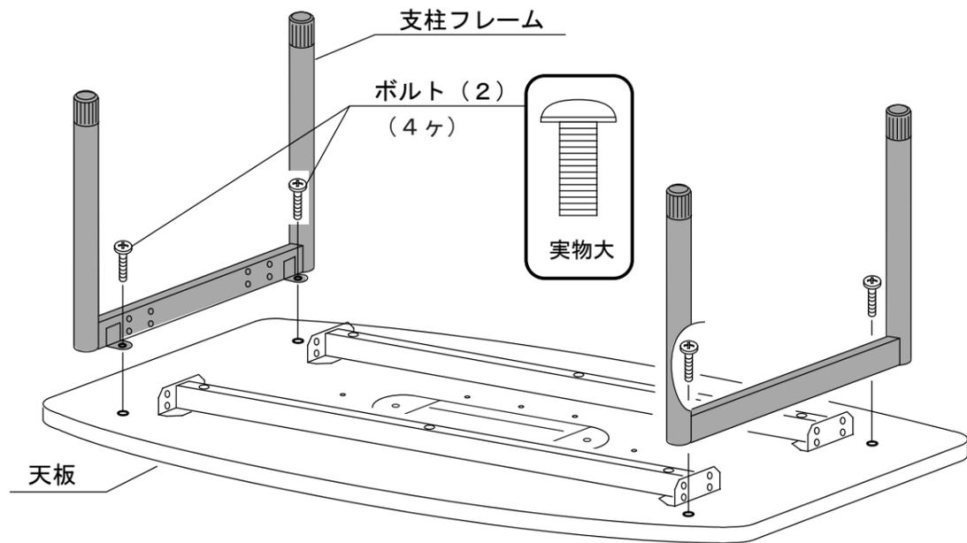
1) 支柱フレームと補強パイプを **仮締め** します。
