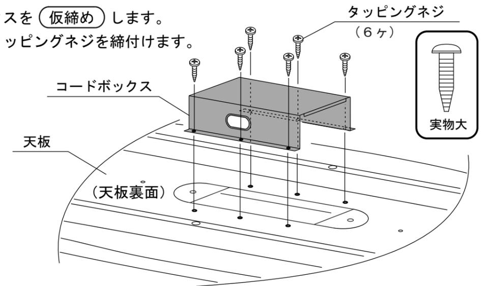
1) ケーブルカバーのマウンティングを締め付けます。
