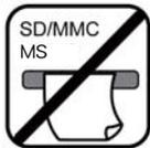
本製品のメモ리카ードスロットには、対応メモ리카ード以外のものを挿入しないでください。スロット内部の金属端子は、異物の挿入により損傷しやすい構造になっています。
