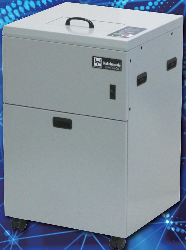
記録メディア媒体の破棄には、適切な情報漏洩対策が求められます。NMD-400は、アタッチメント不要のデュアル投入口で、3.5インチHDDはV字曲げ破壊、2.5インチHDD/SSDは突起のある刃による押し潰し破壊で、効率的な物理破壊を実現します。
