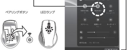
③本製品底面の「ペアリングボタン」を長押しします。
