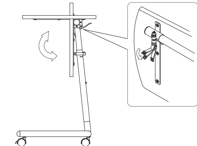
**!** 天板の高さや角度を操作する際は、レバーで確実に固定してください。不意に天板が動き、設置物が落ちたり、けがをする恐れがあります。
